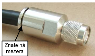
Obrázek 19 Dokončená montáž konektoru TNC
