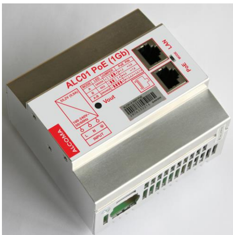
Obrázek 8 Doporučený PoE napájecí zdroj ALC01.H 5501
